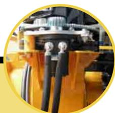
Pompa idraulica per orientamento camino e flap
